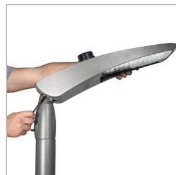
L'angolo di inclinazione può essere regolato in loco per entrambe le configurazioni testa palo (da 0 a +15°) e montaggio laterale (da 0 a -15°).
