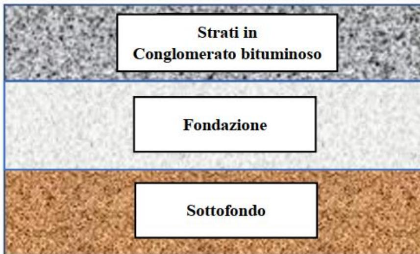
*Figura 1 – Schema qualitativo di pavimentazione*
